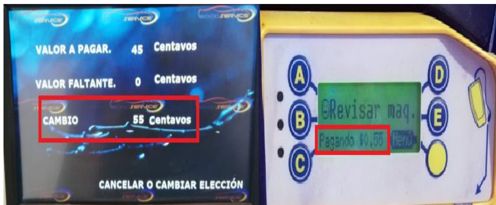
Fig 9. HMI enviado dato al Monedero MEI CF-7000 para devolver el cambio.
