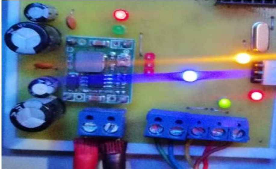
Fig 8. Placa MDB a SERIAL comunicación con el monedero MEI CF-7000.
