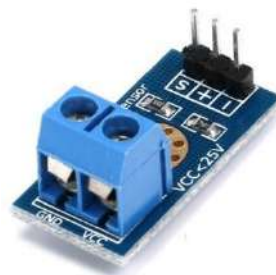
Fig 2. Sensor de Voltaje FZ0430 (Manotoa, 2018)
